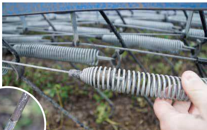
Na maszynie jest zamontowanych 107 zębów. Każdy podtrzymuje systemem oparty na dwóch sprężynach – jednej umieszczonej w drugiej. Końcówki zębów są wykonane z węgla spiekanego, przez co zużywają się znacznie wolniej
