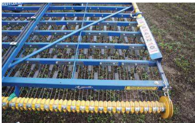
Ustawienie nacisku zębów ułatwia umieszczona na maszynie skala liczbowa. A możliwy zakres oddziaływania każdego zęba na głębę mieści się w zakresie od 100 gramów do 5 kilogramów
