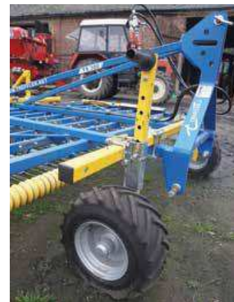
Standardowym wyposażeniem brony chwastownika są dwa przednie koła kopijące. Za dopłatą maszyna otrzymała też tylne koła podporowe
