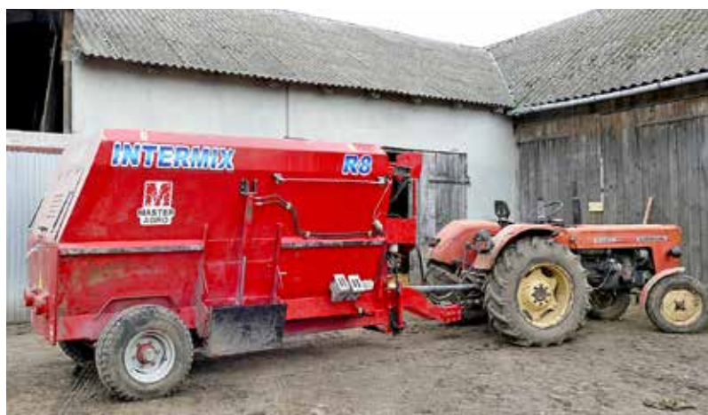
Poziomy wóz paszowy wykonany został specjalnie do bardzo wąskiego korytarza paszowego
