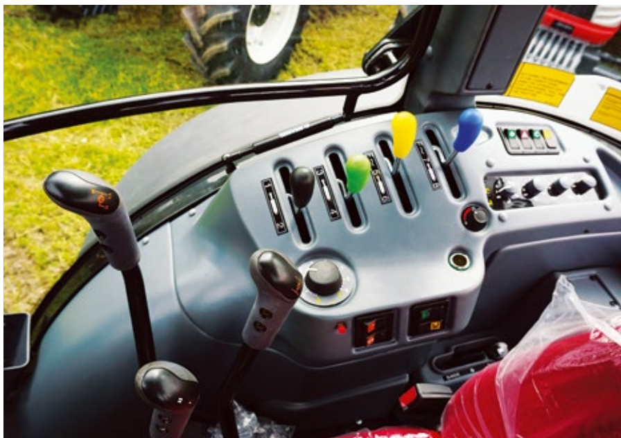
Podnośniki hydrauliczne w mocniejszych modelach serii T są sterowane EHR-em.
